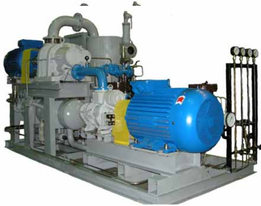
Двухступенчатый винтовой агрегат, производство углекислоты 2т/час
