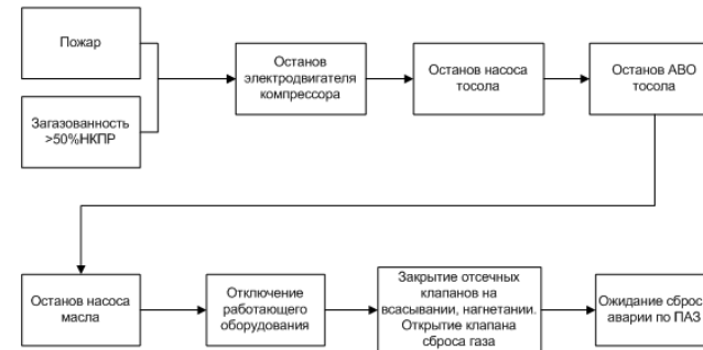
Алгоритм останова компрессора по ПАЗ
